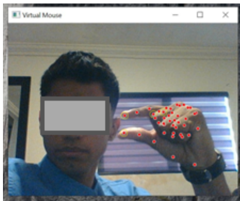
Fig. 3. Detección de dedos específicos para realizar el movimiento del cursor.
